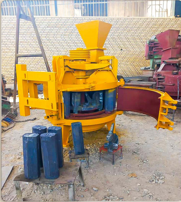
ماسه ساز MS800 (خرگوشی) با اکتروموتور 55kw 30-40 ton/h
