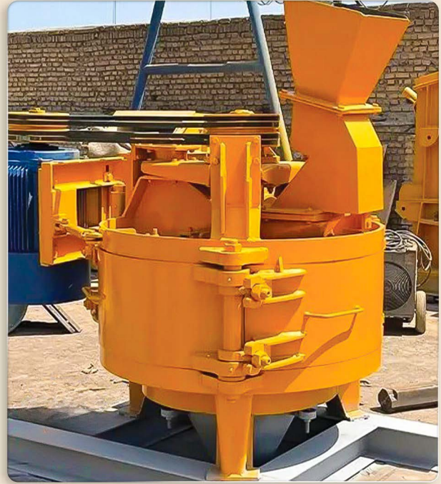
ماسه ساز MS800 (خرگوشی) با اکتروموتور 55kw 30-40 ton/h
